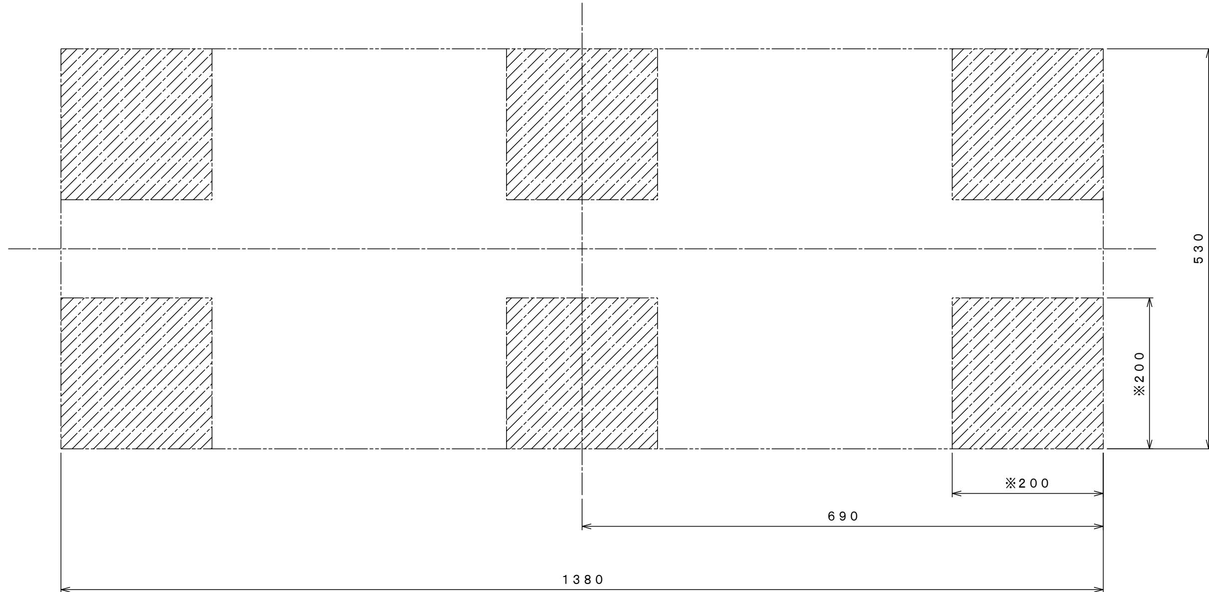
※ 必ずこの範囲内にコンクリート土間、もしくはコンクリートブロックを設置してアンカー固定できる様にして下さい。
