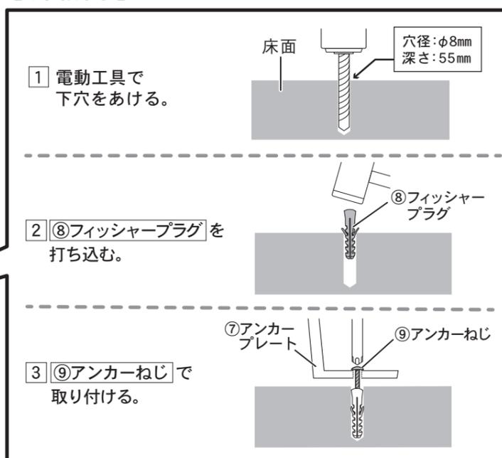
※ ⑧フィッシャープラグは薄いコンクリート面など、破損しやすい箇所への打ち込みは避けてください。上手く固定できない場合や、設置場所の破損のおそれがあります。⑧フィッシャープラグが破損しないようゆっくり叩いて打ち込んでください。
