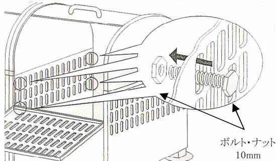
環境ステーションを連結して使用する際は側面のスリット部分の、四隅のできるだけ端を付属のボルト・ナットでしっかりと留め、固定されていることを必ず確認してください。
