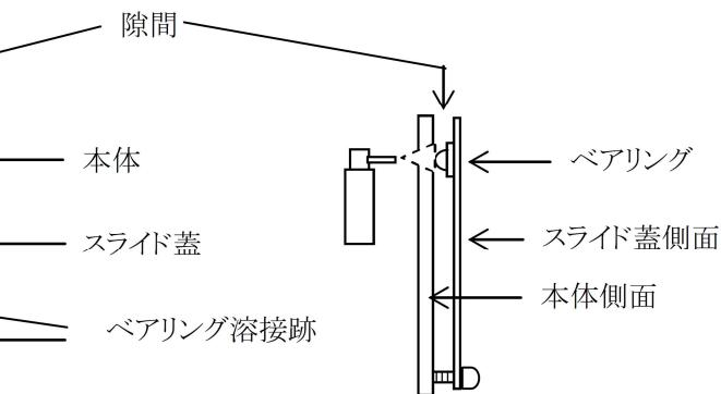
本体とスライド蓋の隙間に搖れ防止のベアリングが左右2ヶ所ずつ内側に取り付けてあります。
