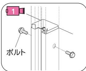
**注意** 壁パネルと下枠に三角形のすきまが発生したり隣同士の棚受け取付けの角孔が上下方向にずれる場合は、下枠の水平、本体の立ちを確認してください。
