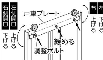
扉前が吊り込みにくい場合は、扉支持材のボルト(3か所)を緩めて吊り込んでください。吊り込み後、ボルトを締めます。
