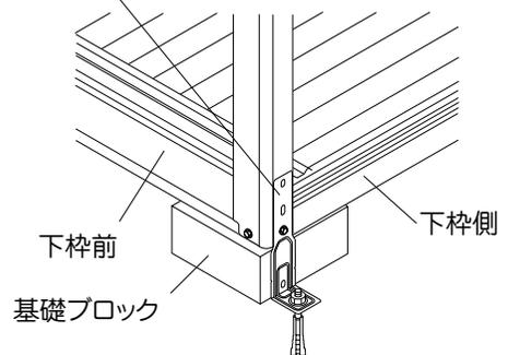
△注意 強風地、寒冷地等に設置する場合、現地の実情(基準風速・凍上による不陸など)にあわせて設計・施工してください。
